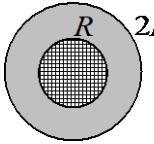
На рисунке показано поперечное сечение провода, изготовленного из двух различных проводников: внутреннего цилиндрического проводника радиуса  $R$  и внешнего проводника в виде цилиндрического слоя. Если при  $r < R$  модуль вектора плотности тока равен  $j_1$ , а при  $R < r < 2R$  равен  $j_2$  ( $r$  – расстояние от оси симметрии провода), то величина тока через сечение провода равна
